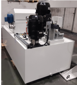
EQUIPO DE REFRIGERACIÓN INTERNA Y EXTERNA
